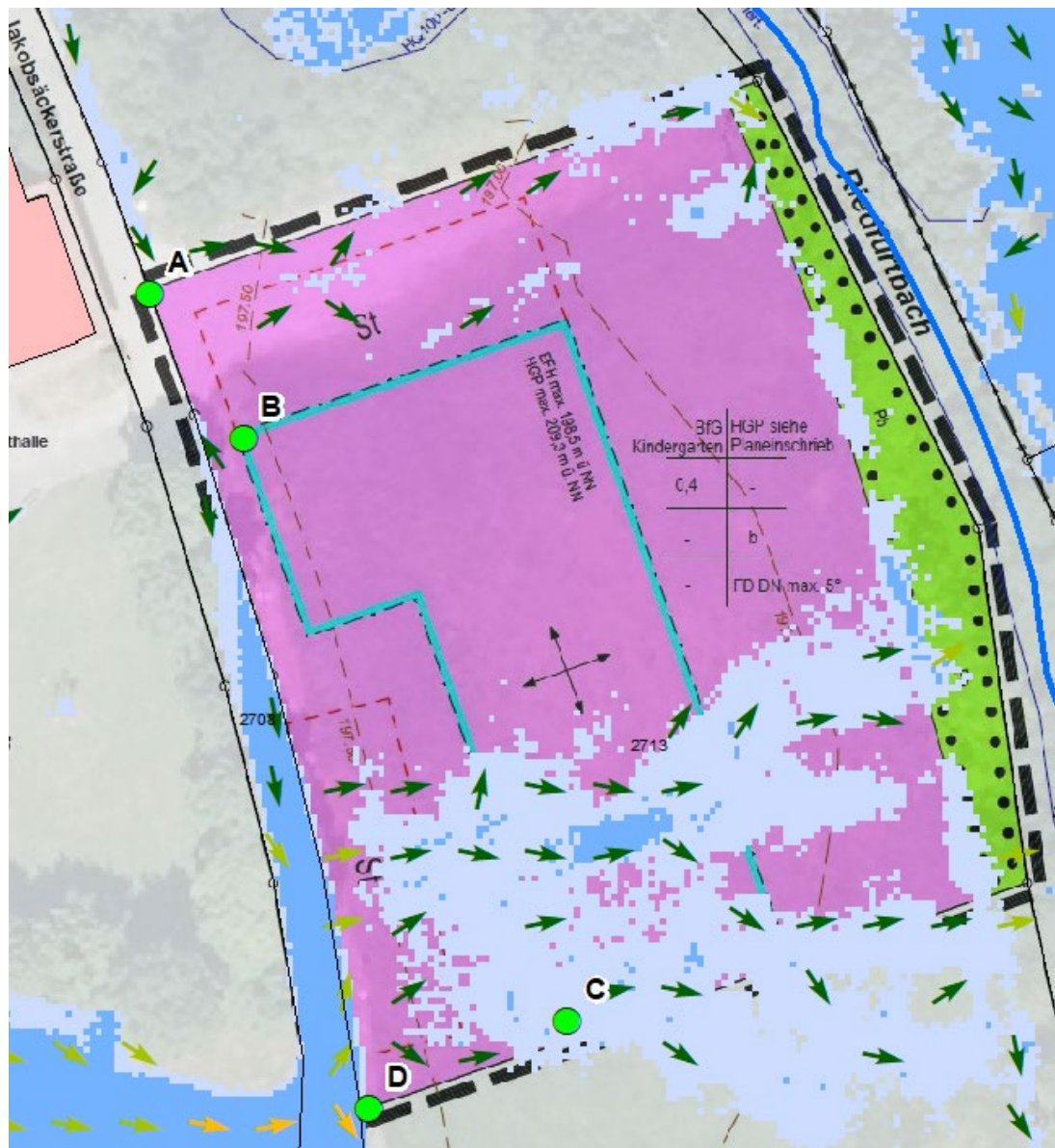
Abbildung 2: Ermittelte Überflutungstiefen und Fließgeschwindigkeiten des Istzustands im Bereich des Bebauungsplan KiTa Jakobsacker bei einem außergewöhnlichen Ereignis [1]
